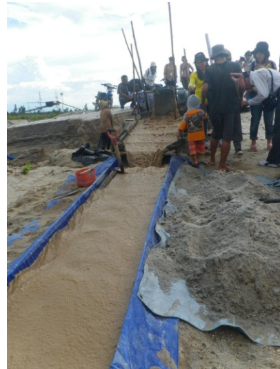
写真 5. 泥水の中から金を採集するためのカーペットスレート
