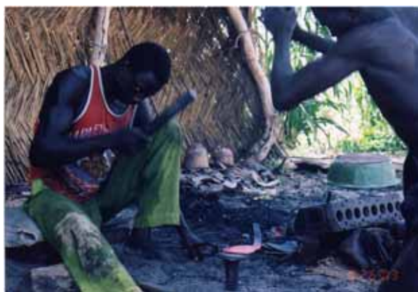
写真 2 二人で交互に、力強く、かつリズムカルに鉄をうがつ。二人の息があわなければならない。
