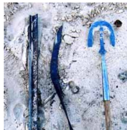
写真 3 押し鋤。鉄の刃や柄の部分は、スクラップの鉄(写真の左 2 本)から作られる。
